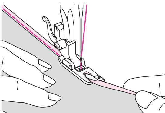
Опустіть важіль підйому притискої лапки та повільно починайте шити, скеровуючи необроблений зріз тканини попереду лапки для підгинання рівномірно до спірального прорізу лапки.
