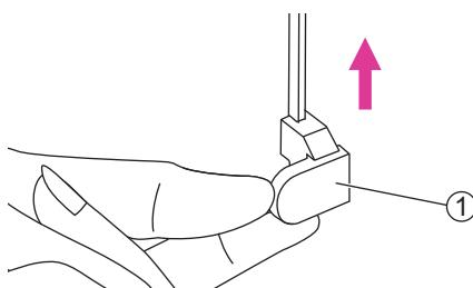
Підніміть важіль підйому притискої лапки та обріжте нитки. Для повторного обметування такої самої петлі підніміть важіль підйому притискої лапки, посуньте тканину, опустіть важіль підйому притискої лапки та починайте шити.
