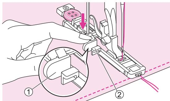
Опустіть обмежувач для обметування петлі вниз до упору. Він має зафіксуватися позаду скоби лапки для обметування.
