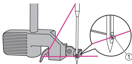
13. Протягніть нитку під гачок попереду голки та впевніться, що нитка зачепилася за гачок.
