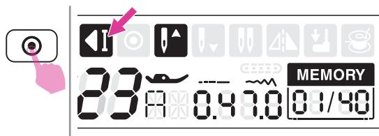
Якщо під час шиття натиснути кнопку автоматичного закріплення строчки, машина зробить 3 закріплувальних стіби по завершенні виконання поточної строчки та зупиниться. На дисплеї відсвічуватиметься індикатор автоматичного закріплення строчки. При натисканні кнопки Старт/Стоп, машина почне шити з наступної строчки.
