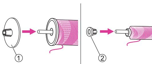
1. Установіть котушку з нитками на стрижень і зафіксуйте котушкотримачем. Для якісного намотування обирайте для котушки відповідний фіксатор.
