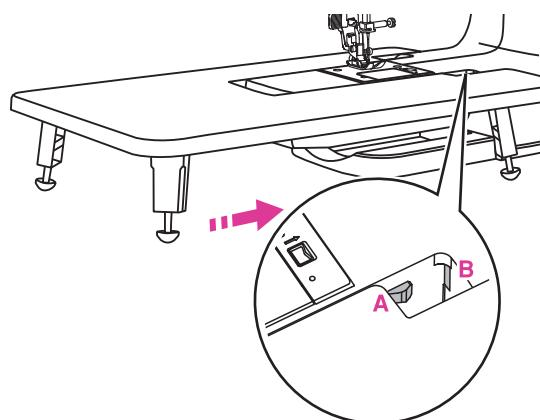
Вставте фіксатор (A) приставного стола в паз (B) на корпусі машини.
