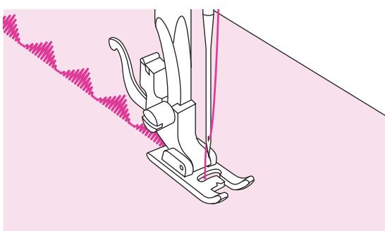
Лапка має паз на нижній поверхні. Це дозволяє щільній строчці вільно просуватися під лапкою.
