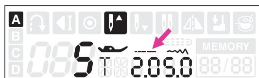
Для регулювання довжини стібка користуйтесь кнопками регулювання довжини стібка «+» чи «-». Естетичнішою виглядає строчка зигзаг із довжиною стібка 2,5 чи менше.
