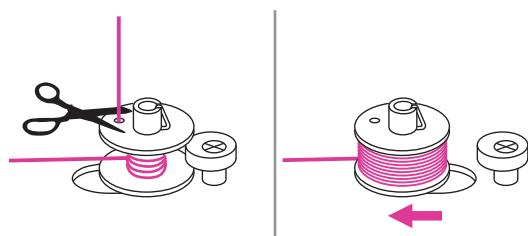
7. Після намотування декількох витків зупиніть машину та обріжте нитку біля отвору шпульки. Потім продовжіть процес до повного намотування на максимальній швидкості. Шпулька почне обертатися повільно. Після завершення намотування зупиніть машину, відпустивши педаль або натиснувши на кнопку Старт/Стоп, і переведіть кронштейн для намотування у крайнє ліве положення.
