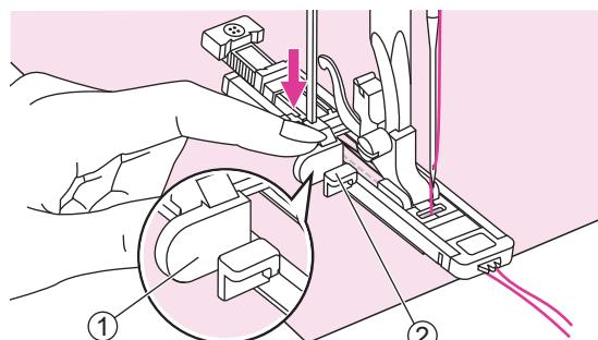
Опустіть обмежувач вниз до упору. Він має зафіксуватися позаду скоби лапки для обметування петлі.
