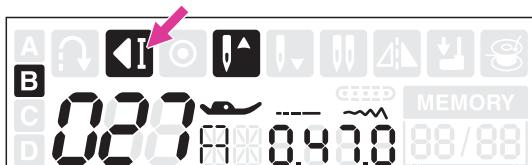
Під час роботи машини: При обранні режимів 6-9 із групи строчок швидкого вибору (A) чи 001-007 і 021-105 із групи основних строчок (B) і натисканні кнопки автоматичного закріплення машина виконає 3 закріплювальні стібки та зупиниться. Щоб деактивувати функцію, повторно натисніть кнопку під час шиття.
