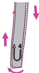
7. Проведіть нитку під пружиною ниткопрятягувача, потім протягніть її вгору в напрямку стрілки (див. мал.).
