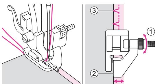
Покладіть тканину під притискну лапку. Повертаючи махове колесо в напрямку до
