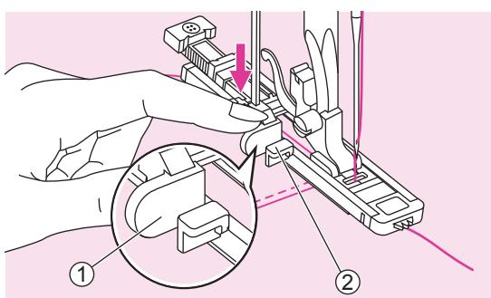
Опустіть обмежувач вниз до упору. Він має зафіксуватися позаду скоби лапки для обметування петлі.
