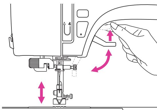
Важіль підйому притискної лапки використовується для підйому чи опускання лапки.
