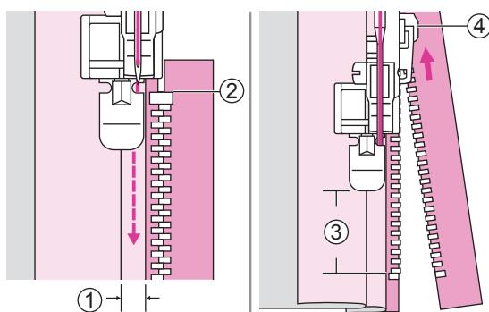
Установіть лапку для пришивання блискавки. Щоб пришити лівий бік блискавки, установіть лапку для вшивання блискавки на тримач лапки так, щоб голка проходила з правого боку лапки. Пришійте блискавку до тканини з виступаючим на 3 мм краєм, починаючи з кінця розкриття блискавки.
