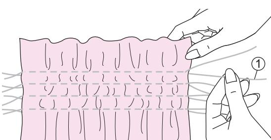
Зав'яжіть кінці ниток на вузлик з одного боку деталі. Потягніть за нижні нитки та рівномірно розправте отримані зборки. Закріпіть нитки з іншого боку деталі.
