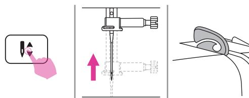
2. Натисніть кнопку підйому/опускання голки, щоб підняти голку та важіль ниткопрятягувача у крайнє верхнє положення.
