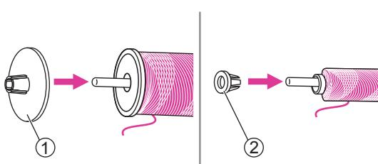
3. Установіть котушку на стрижень. Зафіксуйте її котушкотримачем (фіксатором). Задля якіснішого шиття обираєте фіксатор, що відповідає розміру котушки.
