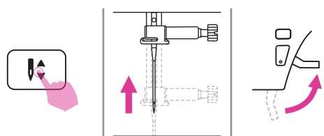
8. Підніміть голку, натиснувши кнопку позицювання (підйому/опускання) голки. Щоб витягти тканину, підніміть важіль підйому лапки.
