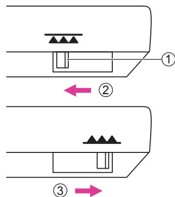
Нижній транспортер допомагає просувати тканину під час шиття. Його зубці мають бути підняті для переважної більшості операцій та опущені для вільно-ходового вистьобування, штопання та вишивання монограм.
