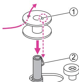
4. Кінець нитки протягніть через отвір шпульки (див. мал.). Установіть шпульку на кронштейн для намотування. Потім порівняйте отвір шпульки з фіксатором кронштейна для намотування.
