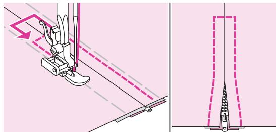
Прострочіть навколо блискавки, а потім видаліть нитки наметування.
