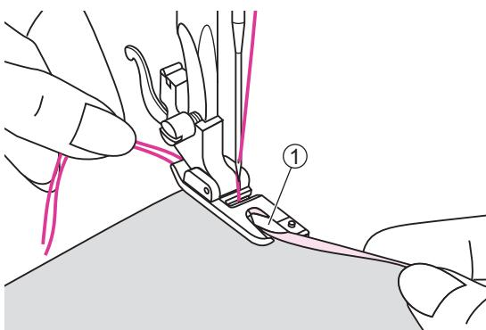
Опустіть голку в отриману складку, повертаючи махове колесо в напрямку до себе. Опустіть важіль підйому притискої лапки. Зробіть кілька стібків і підніміть важіль підйому притискої лапки.
