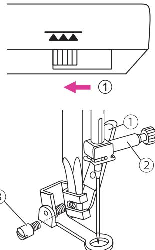
Зніміть притисну лапку та лапкотримач, установіть лапку для штопання/вишивання на лапкотримач. Важіль лапки має знаходитися позаду гвинта кріплення голки. Щільно притисніть лапку для штопання та вишивання до штоку і затягніть гвинт кріплення.
