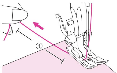
4. Покладіть тканину під притискну лапку. Протягніть нитку під лапкою і витягніть кінець нитки довжиною 10 см в напрямку від себе.
